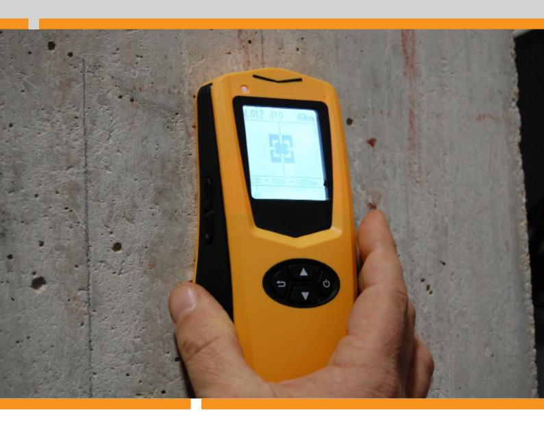
Lo strumento PACOMETRO SGS 120X è conforme alla norma BS1881–204~
